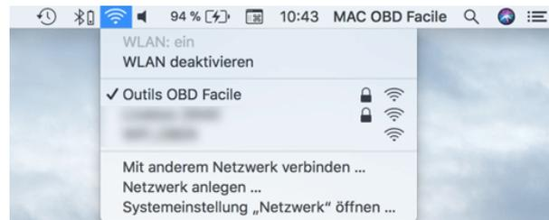
Sobald Sie mit dem WLAN-Netzwerk der Schnittstelle verbunden sind, kehren Sie zu EOBD-Easy zurück, um die Verbindung zu starten, indem Sie die ELM327 WLAN-Schnittstelle auswählen. Starten Sie die Verbindung. Die Software verwendet die Einstellungen in den Software-Einstellungen.
